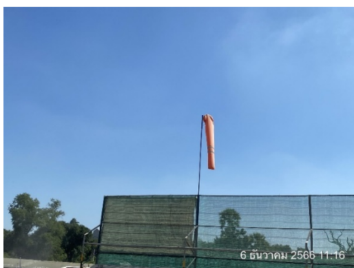
รูปที่ 2.2-16 การติดตั้งถุงลม (Wind Sock) บริเวณหน้าท่าเทียบเรือ เพื่อใช้เป็นเครื่องมือในการสังเกตทิศทางลมและความเร็วลม
