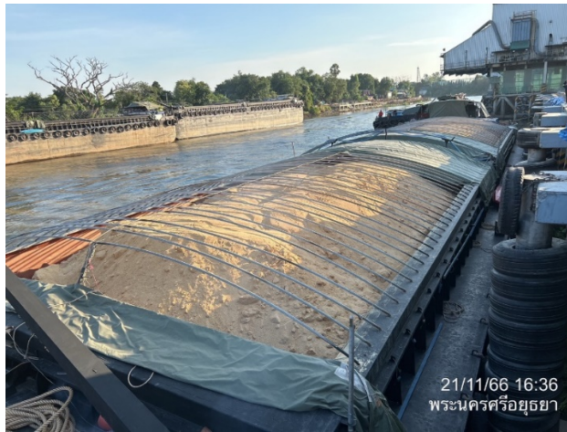
รูปที่ 2.2-14 การบรรทุกสินค้าไม่เกินร้อยละ 70 ของระวางเรือ และกองสินค้าต้องไม่เกินโค้งเรือ
