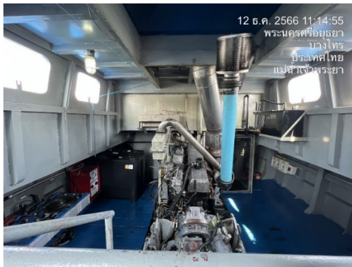
รูปที่ 2.2-25 เรือยนต์ลากจูงที่ติดตั้งตัวเก็บเสียง (Silencer)
